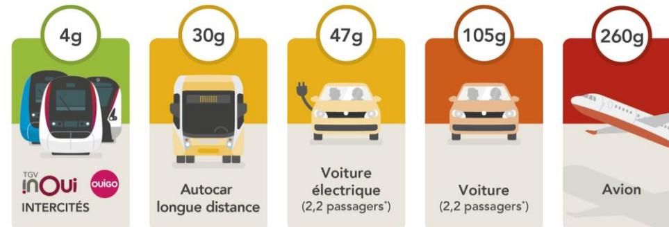
Émissions CO<sub>2</sub> liées à la consommation d'énergie et à la construction/entretien du véhicule.
